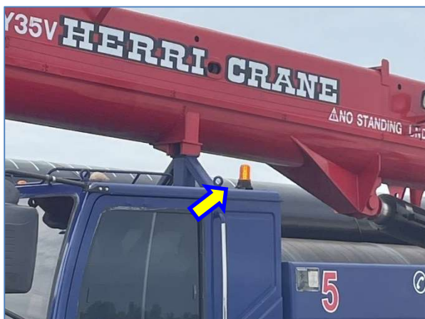
รูปที่ 2.2.1-39 เครื่องจักรที่ติดไฟกระพริบขณะทำงาน
