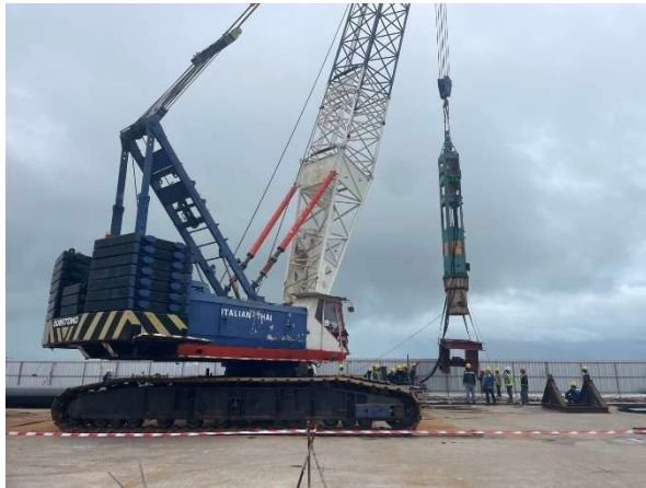
รูปที่ 2.2.1-13 Hydraulic Hammer ที่ใช้ในการก่อสร้างป็นจัน
